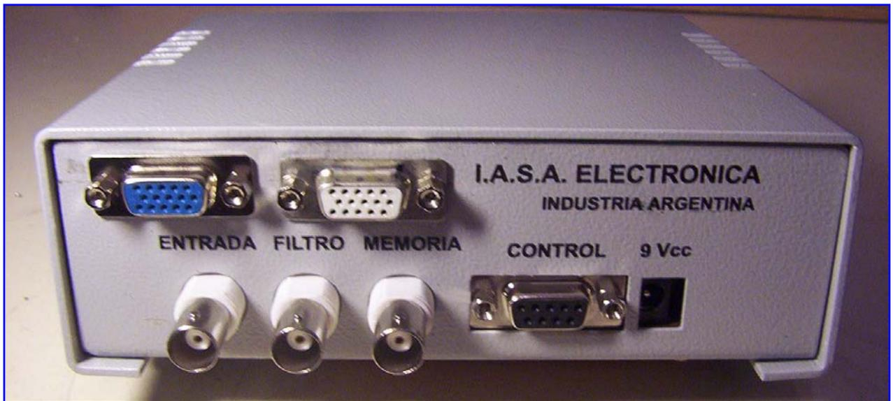
b) Conectar el segundo monitor al conector marcado como "MEMORIA". El monitor debe estar terminado en 75 ohms. Si el equipo incluye salidas para monitor SVGA conectar estos en los conectores DB15 hembra. El de la izquierda corresponde a la salida directa con filtro recursivo y el de la derecha a la salida de las memorias del banco de expansión.
